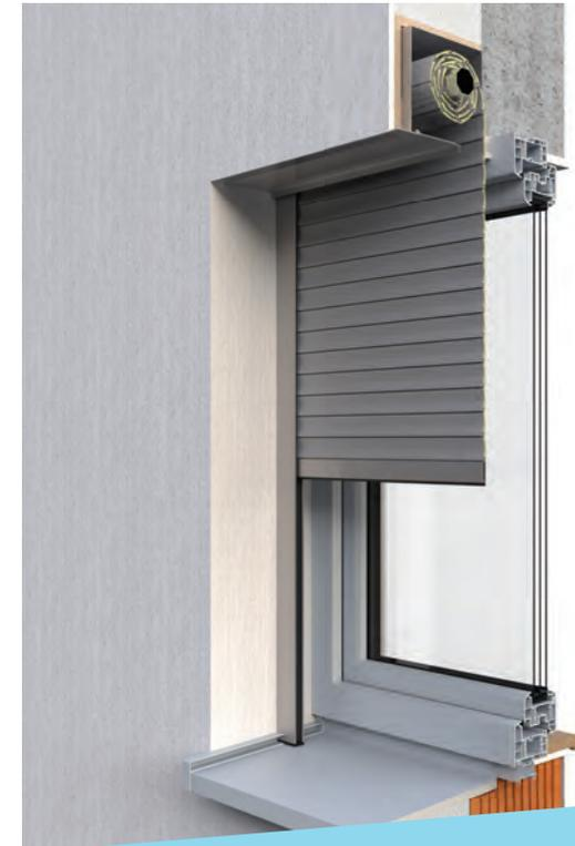
Die Lamellen werden in einen verdeckten Unterputzkasten eingerollt. Ein Bestandteil des Kastens ist extrudierter Polystyrol-Hartschaum (XPS), der sich durch hervorragende Dämmeigenschaften auszeichnet. Nach dem Hochziehen des Rollladens bleiben nur die Führungsschienen,
